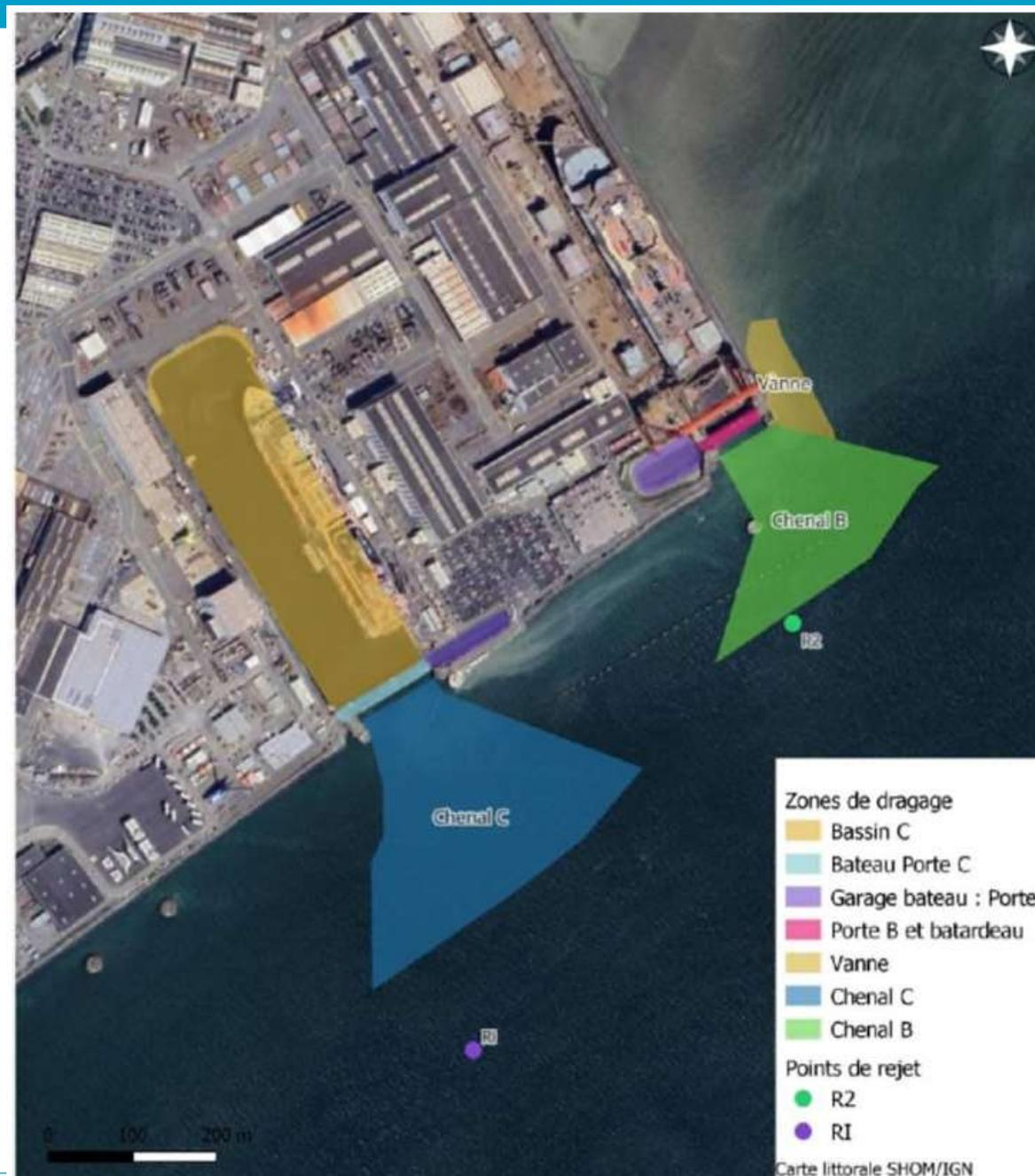
FIGURE 4 : LOCALISATION DES ZONES DE DRAGAGE ET DES POINTS DE REMISE EN SUSPENSION DANS L'ESTUAIRE (CREOCEAN 2013)
