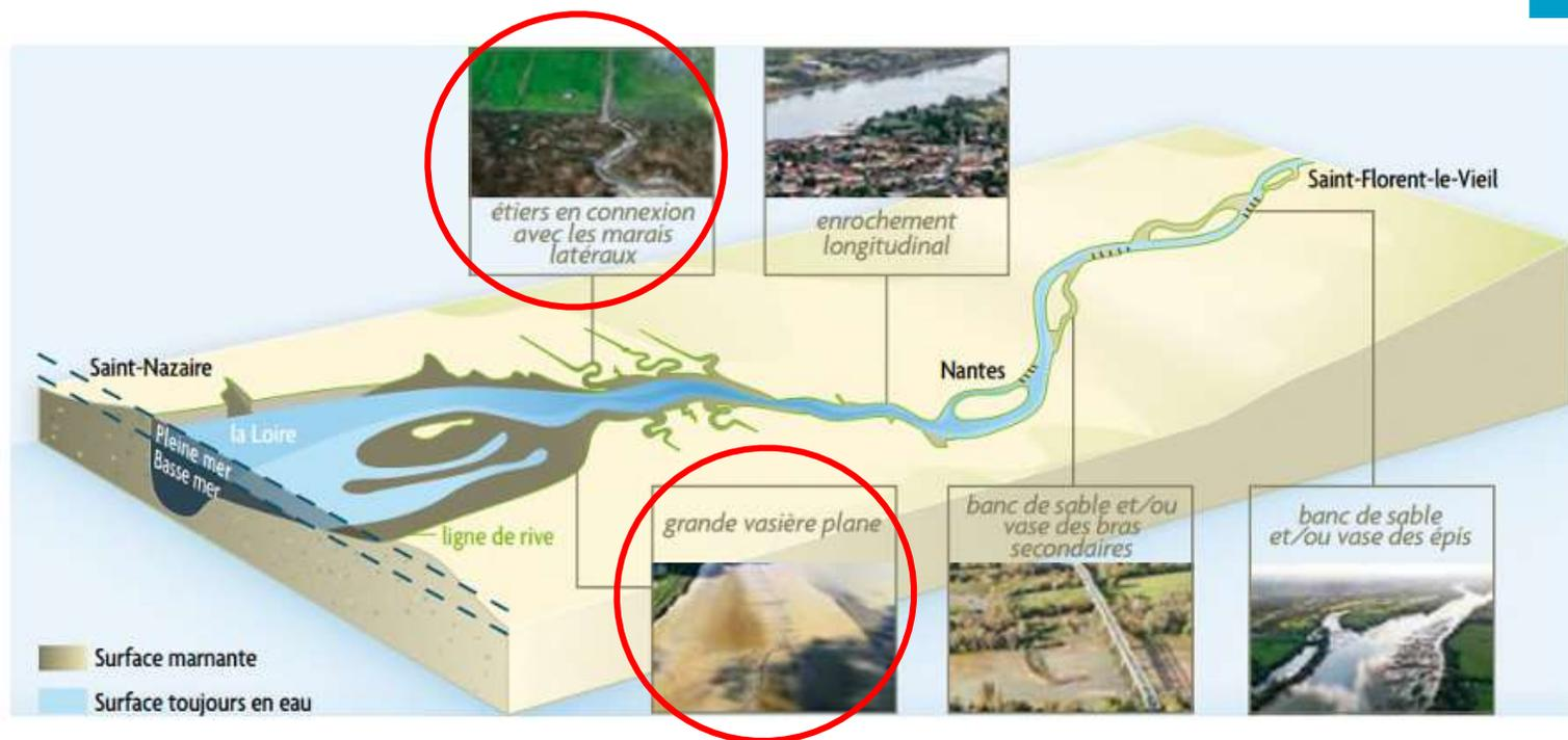
FIGURE 38 : TYPOLOGIE DES SURFACES MARNANTES (GIP LE)
