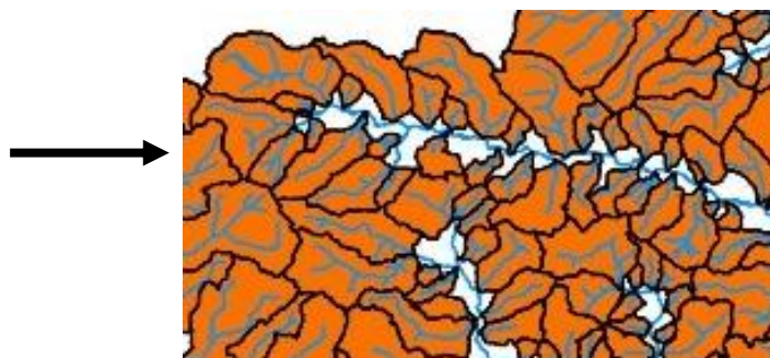
Figure N°4 : principe de la délimitation des bassins versants topographiques grâce au modèle numérique de terrain
