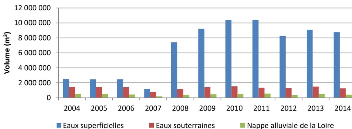
Figure 17: Évolution des prélèvements pour l'irrigation selon le type de ressource entre 2004 et 2014
