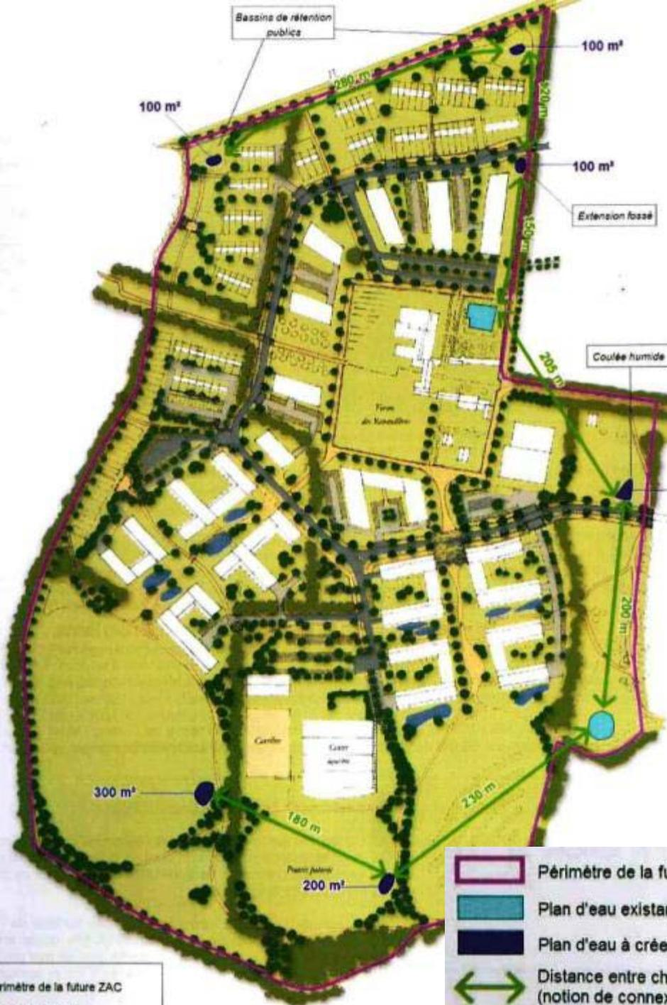
Les mares sont créées dans un objectif de biodiversité (notamment pour le maintien des amphibiens présents sur la zone). La taille des mares variera entre 100 et 300 m<sup>2</sup>. Dans les bassins de rétention, elles seront créées par surcreusement afin de conserver la capacité de rétention du bassin.
