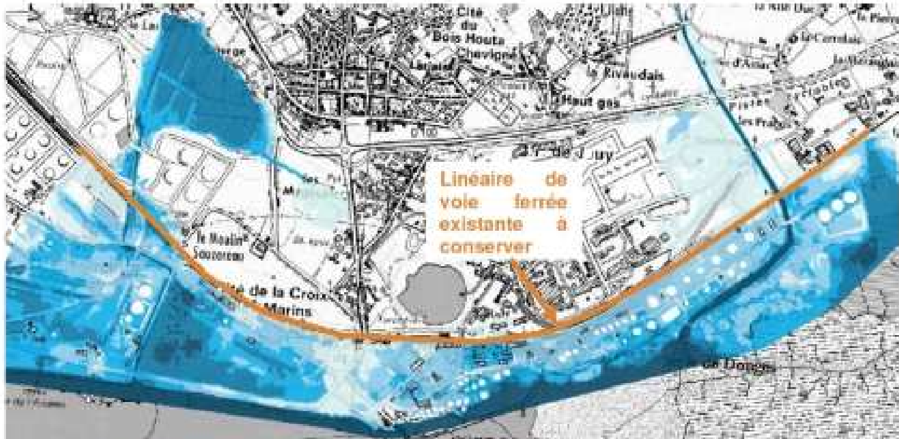
Fig. 133. Remblai de voie ferrée à conserver [STUCKY- 2014]
