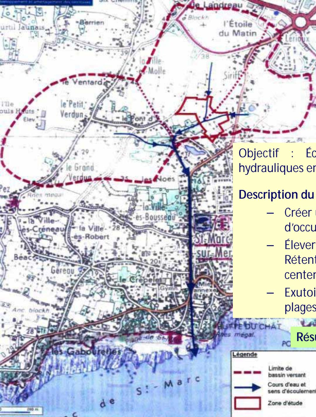
Objectif : Écrêter débits amont en crue, problèmes hydrauliques en aval par le passé.
